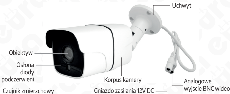
Rys. 1. Budowa kamery
